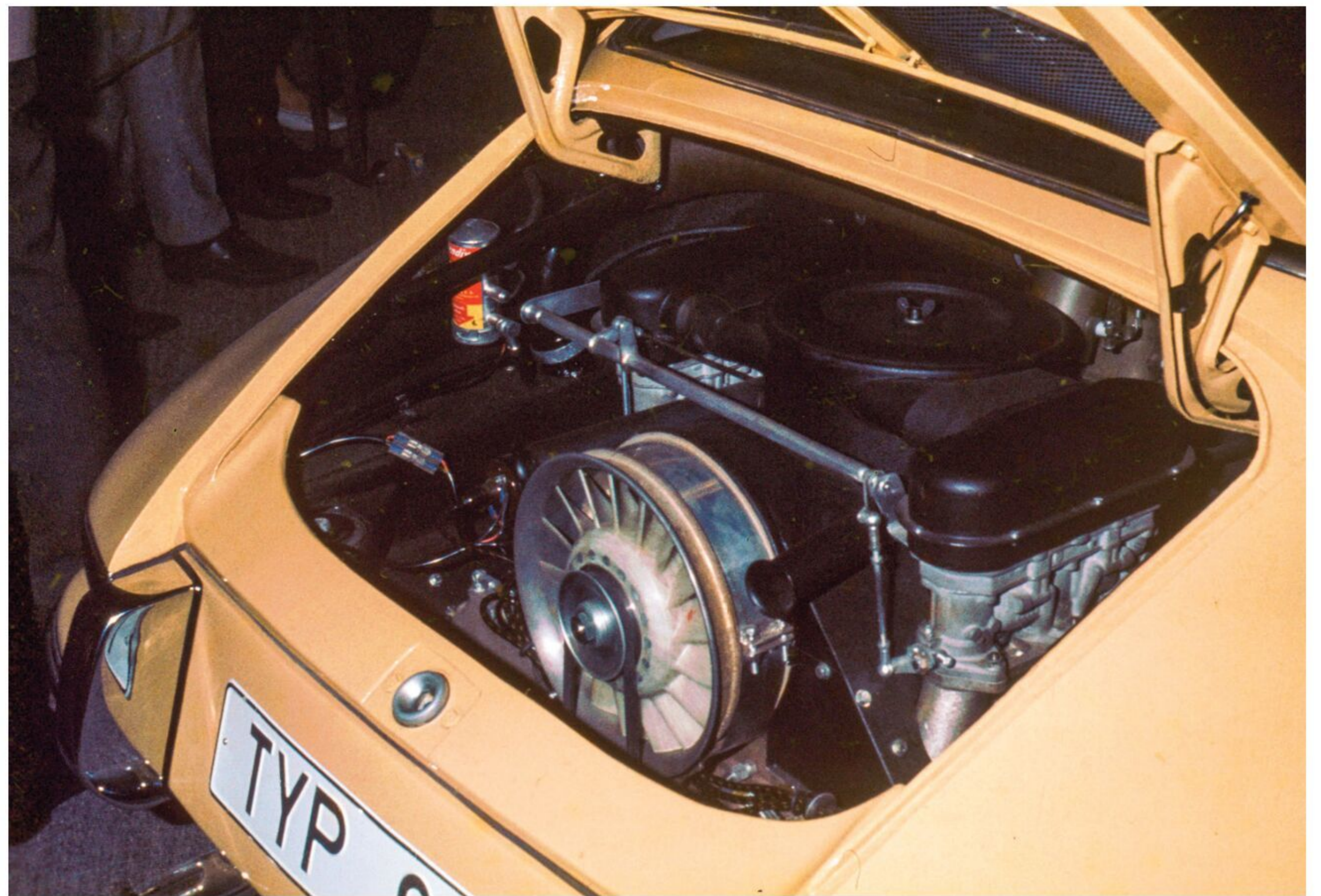
Ausstellungsstück: Weil der neu konstruierte Sechszylinder-Boxermotor 1963 noch nicht verfügbar war, fand sich im Heck des auf der IAA 1963 gezeigten 901 das Vorgänger-Triebwerk vom Typ 821.
